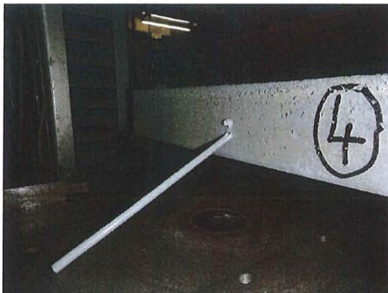
Bild 10: Bruchbild GFK-Dübel – Abscheren / Bruch Dübel
