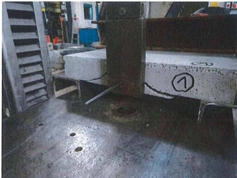
Bild 8: Bruchbild Metalle Dübel – Ausbruch Mörtel
