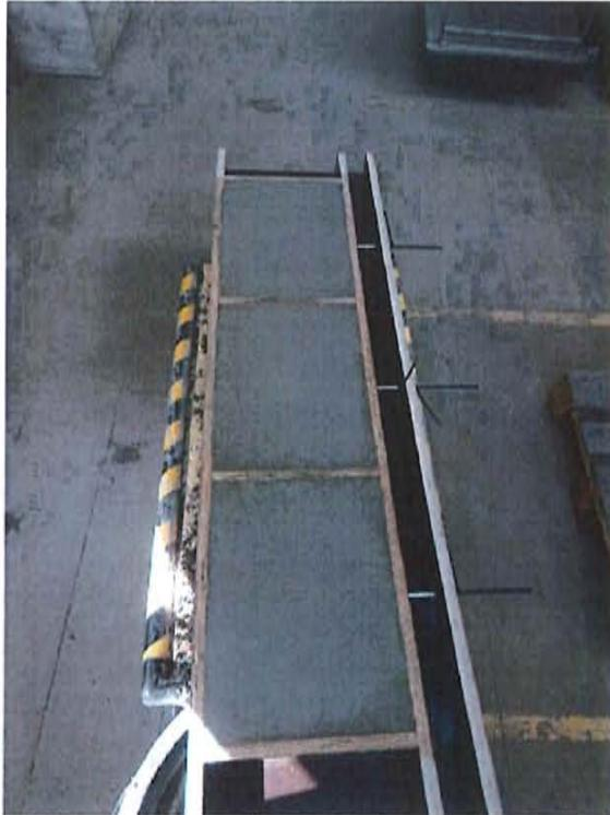
Bild 3: Prüfkörperherstellung – Einbringen des Estrichs
