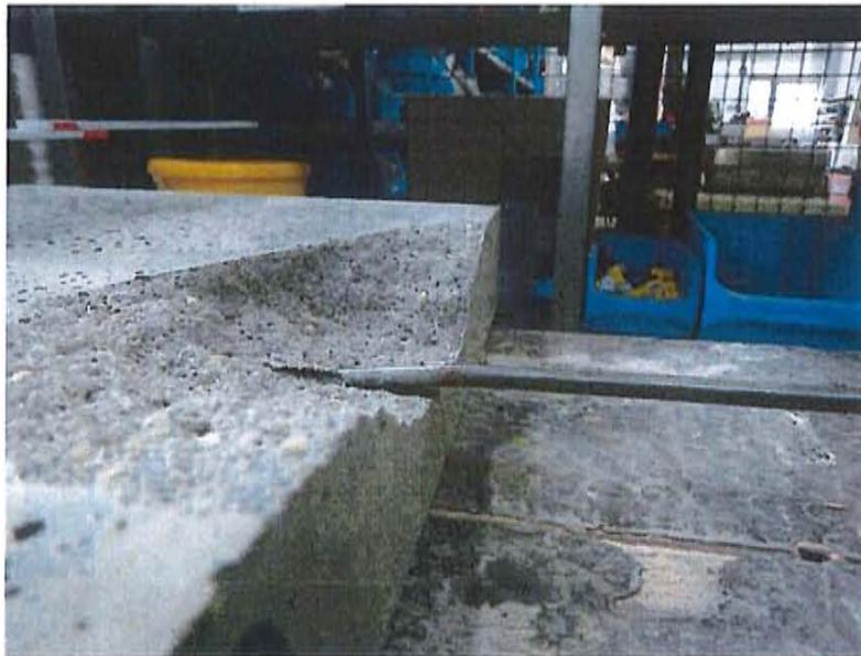
Bild 9: Bruchbild Metalldübel – Ausbruch Mörtel
