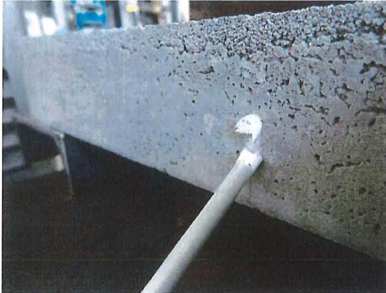
Bild 11: Bruchbild GFK-Dübel – Abscheren / Bruch Dübel
