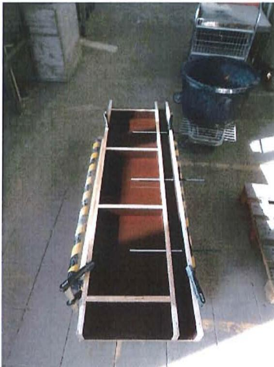
Bild 2: Schalung zur Prüfkörperherstellung
