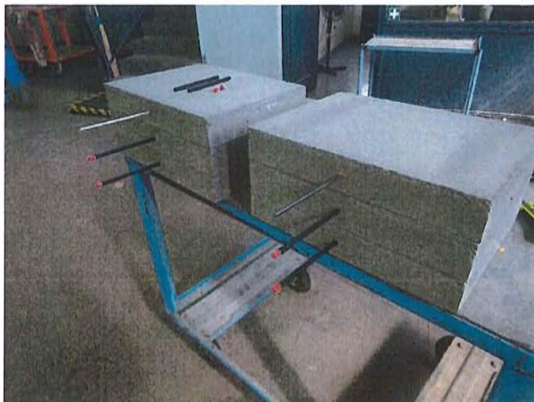
Bild 4: Ausgeschaltete Prüfkörper
