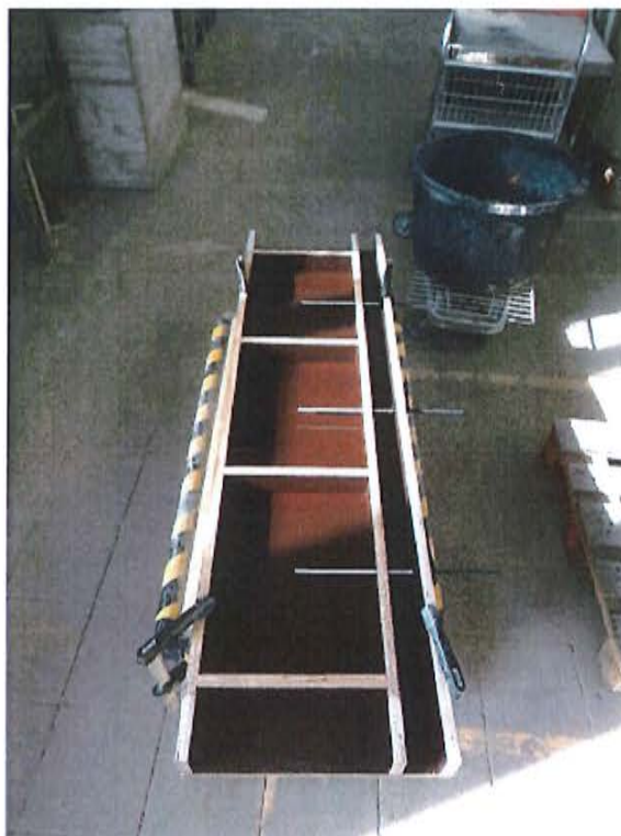
Bild 2: Schalung zur Prüfkörperherstellung
