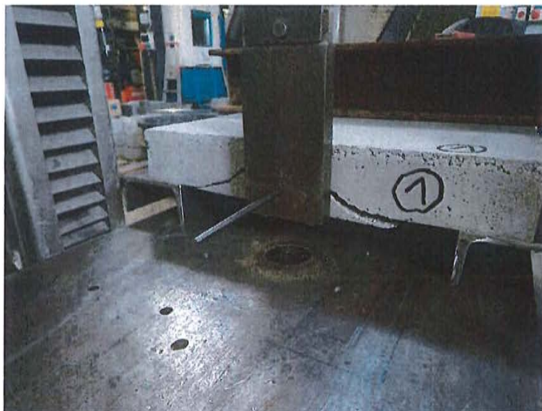
Bild 8: Bruchbild Metalldübel – Ausbruch Mörtel
